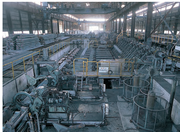
●全自動定尺切断結束(筑波工場)
